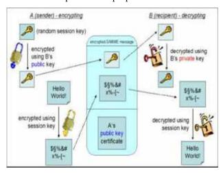
Gambar 5. Proses enkripsi/dekripsi pesan S/MIME
