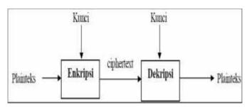
Gambar 3. Diagram proses enkripsi dan dekripsi
